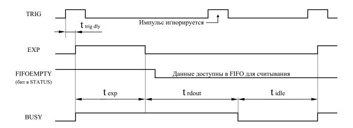
По окончании цикла съемки оцифрованный кадр оказывается записанным в буфер FIFO камеры. Он может быть считан оттуда приложением пользователя сразу же, либо позже. Можно осуществить несколько циклов съемки, после чего считать все данные, но следует учитывать возможность переполнения буфера FIFO. Число кадров, помещающееся в буфере, зависит от размера зоны считывания (ROI\_SIZE). Процесс считывания из камеры в компьютер может быть совмещен с циклом съемки следующего кадра.
