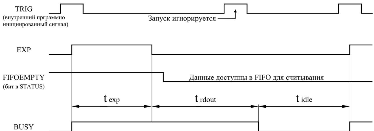
По окончании цикла съемки оцифрованный кадр оказывается записанным в буфер FIFO камеры. Он может быть считан оттуда приложением пользователя сразу же, либо позже. Можно осуществить несколько циклов съемки, после чего считать все данные, но следует учитывать возможность переполнения буфера FIFO. Число кадров, помещающееся в буфере, зависит от размера зоны считывания (ROI\_SIZE). Процесс считывания из камеры в компьютер может быть совмещен с циклом съемки следующего кадра.
